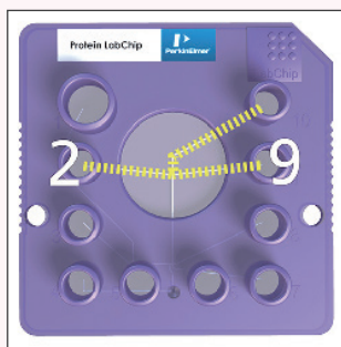
图5A . IntelliChip技术实时调整分离电压和脱色电流
