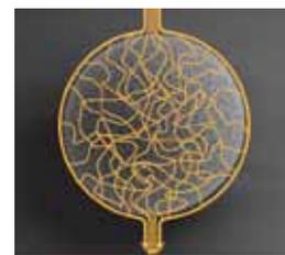
图2. POROS™独有的灌注层析技术POROS颗粒具有大孔径，可提供高的动态结合载量同时降低了扩散对层析的影响。
