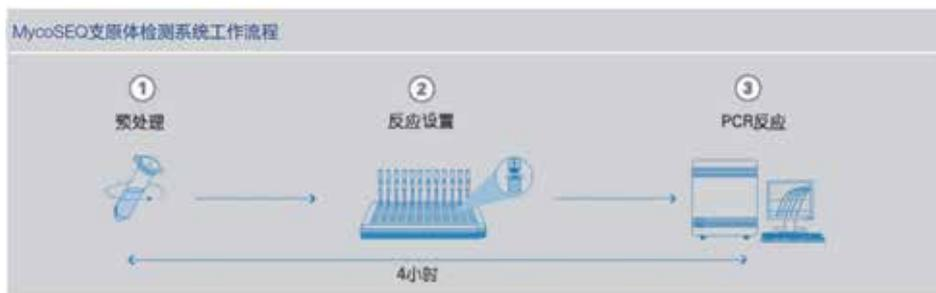
图3. MycoSEQ支原体检测系统可在4小时内获得结果, 可用于在线检测和终产品检测。
